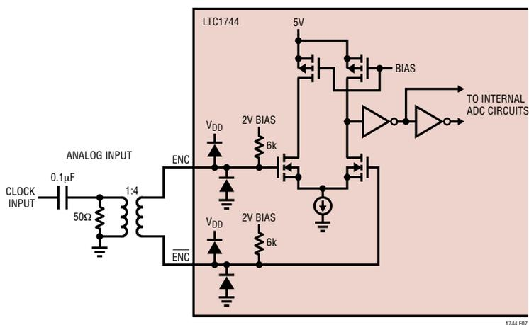
图 7 : 变压器驱动的  $\text{ENC}/\overline{\text{ENC}}$
