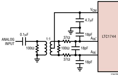
图 3：采用一个变压器的单端至差分转换
