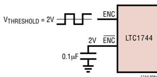
图 8a：单端 ENC 驱动，建议不要在低抖动条件下使用
