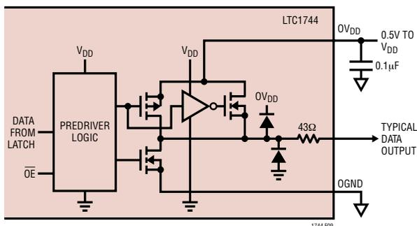
图 9：一个数字输出缓冲器的等效电路
