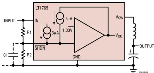
图 4：欠压关断
