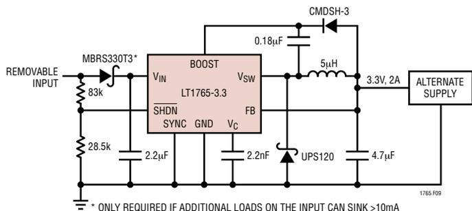
图 9：带 6µA 反向漏电流的双电源系统
