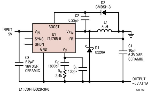
图 12：正至负低输出纹波转换器
