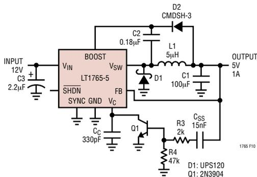
图 10：具可调软启动的降压转换器
