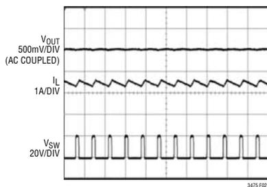
图 2： $V_{IN(MAX)} = 20V$  条件下的运作。
