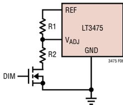
图 6：利用一个 MOSFET 和电阻分压器来调光
