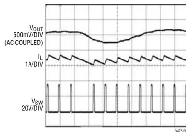
图 3：在高于  $V_{IN(MAX)}$  电压条件下的运作。
