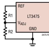
图 5：利用一个电阻分压器来设定 V<sub>ADJ</sub>
