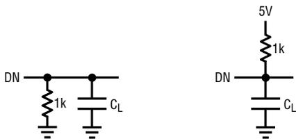
(A) Hi-Z to V<sub>OH</sub> AND V<sub>OL</sub> TO V<sub>OH</sub> (B) Hi-Z to V<sub>OL</sub> AND V<sub>OH</sub> TO V<sub>OL</sub>
