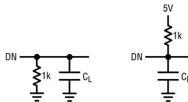
(A) V<sub>OH</sub> TO Hi-Z (B) V<sub>OL</sub> TO Hi-Z
