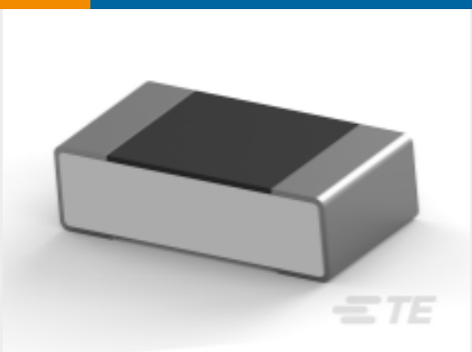
TE 产品编号1-2176370-9 RQ 0603 665R 0.1% 10PPM 5K RL
