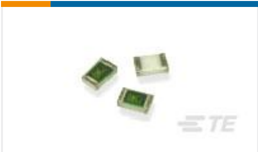
TE 产品编号1676445-2 RN 0805 82R5 0.1% 10PPM 1KRL
