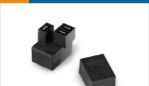
TE 产品编号1558666-6 PCB 功率继电器：30 安培，单稳直流
