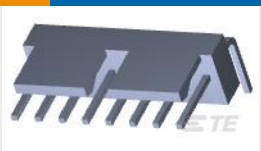
TE 产品编号3-647117-8 08P MTA100 HDR HT FL 30AU LF
