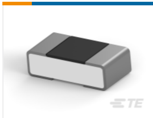
TE 产品编号1-2176359-1 RQ 0402 51R1 0.1% 10PPM 1K RL
