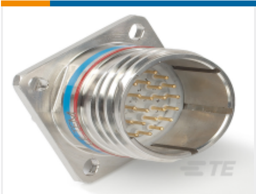
TE 产品编号YDTS20F23-53AA0000 D38999：方形凸缘，23-53 插件
