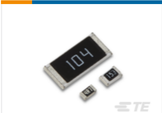
TE 产品编号1-2176344-1 CRGCQ 1206 47R 5%
