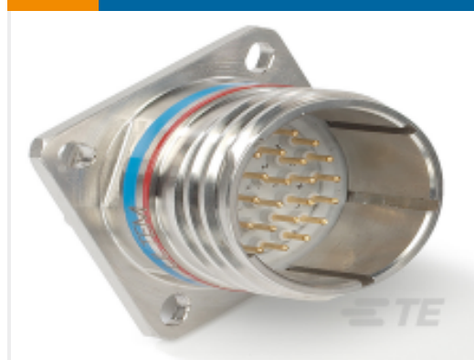
TE 产品编号DTS20W13-35PN D38999：方形凸缘，13-35 插件
