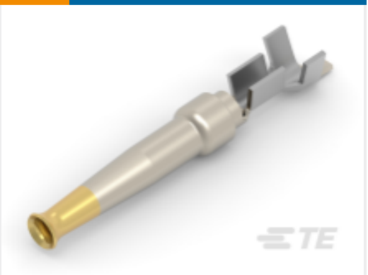
TE 产品编号745230-4 D-Sub 连接器端子：插座，磷青铜，信号，20 号
