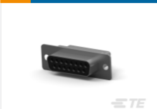
TE 产品编号205205-7 D-Sub 压接插座，信号，15 针脚，20 号插座，外壳尺寸 2
