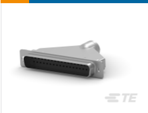
TE 产品编号205210-8 D-Sub 压接：插头，信号，37 针脚， 20 号插针，外壳尺寸 4
