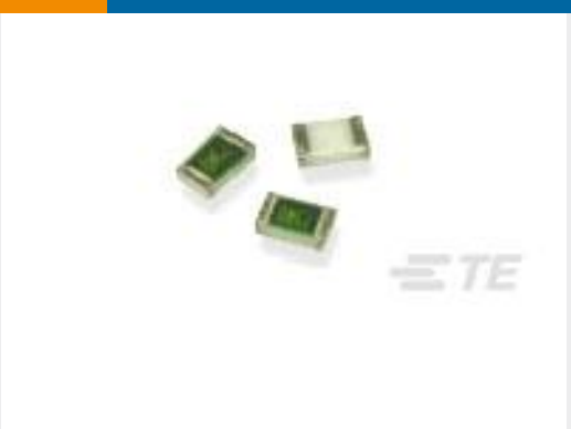
TE 产品编号1676142-3 RN 0805 100K 0.1% 10PPM 5KRL
