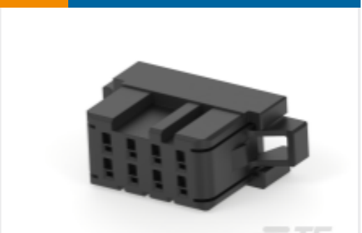
TE 产品编号1-1871946-4 Dynamic 1900D 母端壳体压接类型
