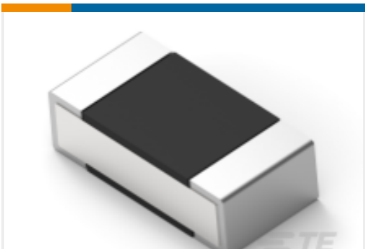
TE 产品编号9-2176305-7 RP 1E 0.1W 1K07 0.1% 25PPM 5K RL
