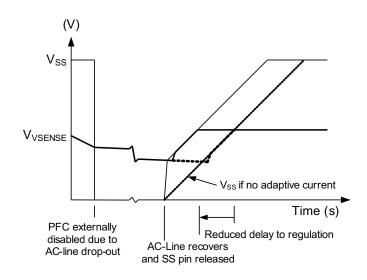
Figure 21. Soft-Start Ramp Rate
