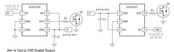
图 25. Using Inverting Input
