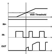
图 21. Power Up (Noninverting Drive)
