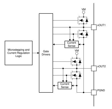
图 12. PWM Motor Driver Block Diagram
