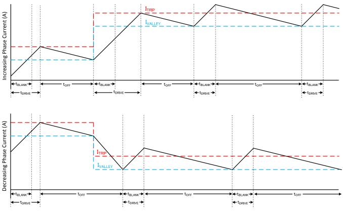
图 23. Smart tune Ripple Control Decay Mode
