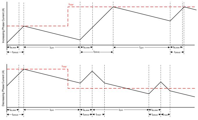
图 22. Smart tune Dynamic Decay Mode
