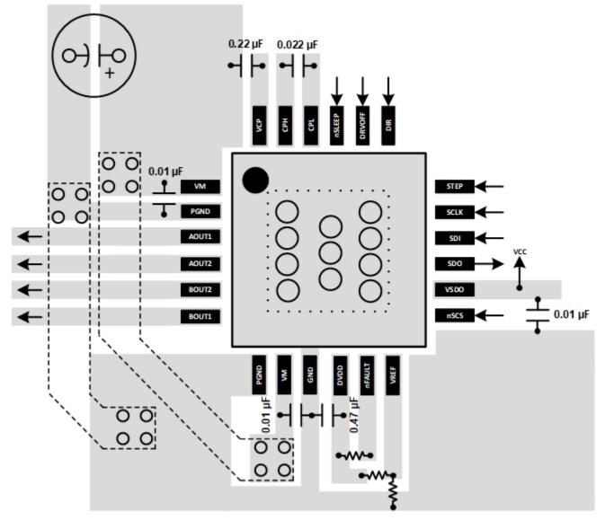
图 74. QFN Layout Recommendation
