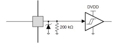
图 26. Logic-Level Input Pin Diagram
