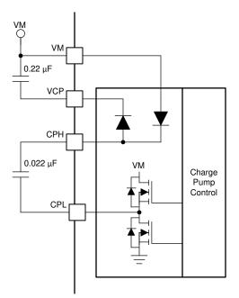
图 24. Charge Pump Block Diagram
